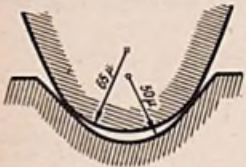
Bild 1. Nadel- und Rillenprofil für Normalplatten (78 Uml/min)
