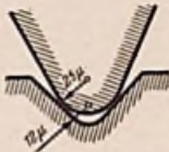
Bild 2. Nadel- und Rillenprofil für Schmalrillenplatten (Mikrogroove)
